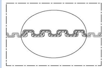
**Polyamid ummantelter Metall-Schutzschlauch; robust und flüssigkeitsdicht; eingehaktes Metallprofil**
